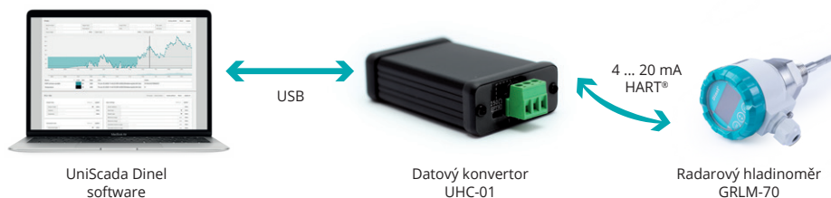
Obr. 47: Připojení periferních zařízení protokolem HART® pomocí UHC-01
