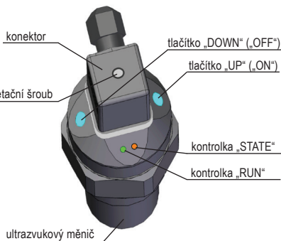
Obr. 31: Hlavní části měřicího zařízení (verze s tlačítky)
