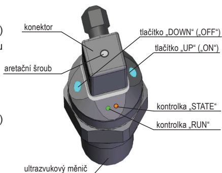
Obr. 29: Hlavní části měřícího zařízení (verze s tlačítky)
