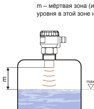
Минимальное удаление измерителя уровня до максимального уровня
