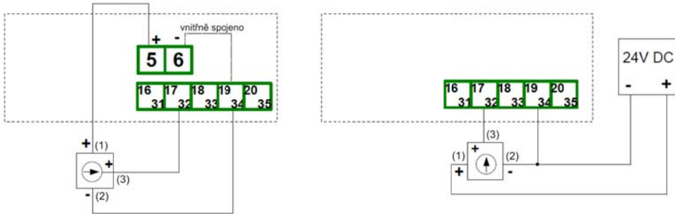
Obrázek 4.7. Schéma připojení hladinoměru s napěťovým výstupem k jednotce PDU
