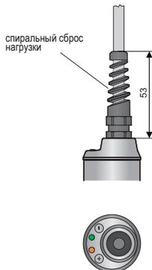
Исполнение «H» с выводом для защитного шланга - для применения в наружной среде в местах с повышенной влажностью.
