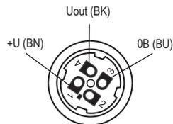
Рис. 6: Вид изнутри гнезда разъёма (вариант "C")
