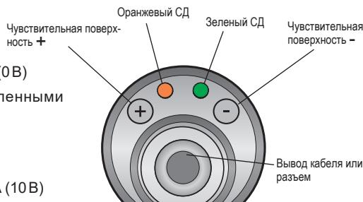
Рис. 7: Вид сверху на датчик
