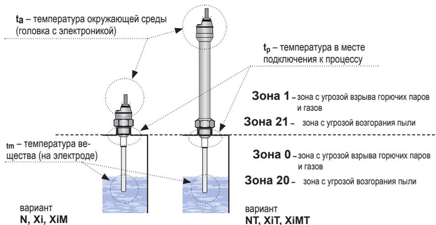
Рис. 8: Изображение мест измерения температуры и зон взрывоопасности
