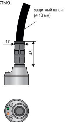
Исполнение «D» с металлическим пыленепроницаемым выводом
