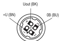
Рис. 6: Вид изнутри гнезда разъёма (вариант "С")
