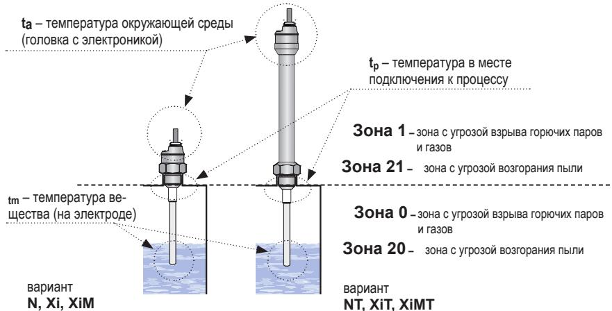
Рис. 8: Изображение мест измерения температуры и зон взрывоопасности
