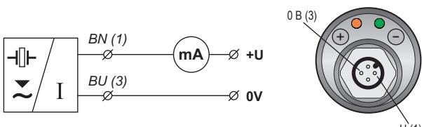
Рис. 4: Схема подключения и вид изнутри разъёма уровнемера DLM (вариант - I)
