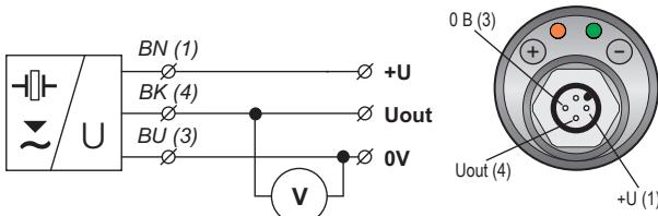
Рис. 5: Схема подключения и вид изнутри разъёма уровнемера DLM (вариант - U)
