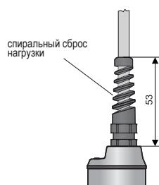
Исполнение «Н» с выводом для защитного шланга - для применения в наружной среде в местах с повышенной влажностью.
