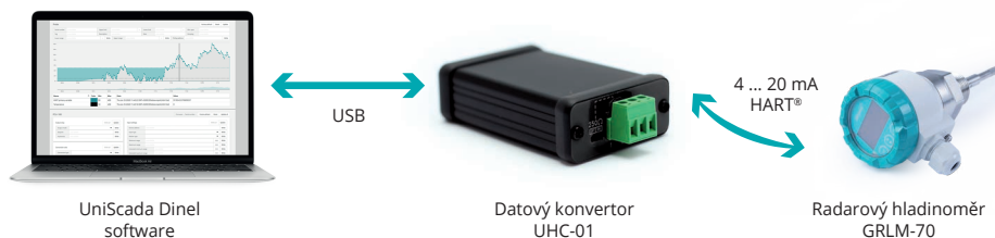
Obr. 47: Připojení periferních zařízení protokolem HART® pomocí UHC-01
