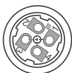
vnitřní pohled na svorky konektoru
