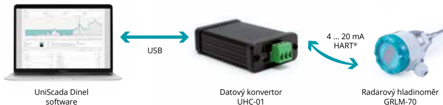
Obr. 47: Připojení periferních zařízení protokolem HART® pomocí UHC-01
