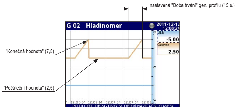
Obr. 88: Vliv parametru "Tvar" s možností "sklon" na křivce generovaného profilu
