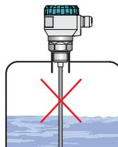
Abb. 6: Falsche Anschweißflanschmontage am Tank
