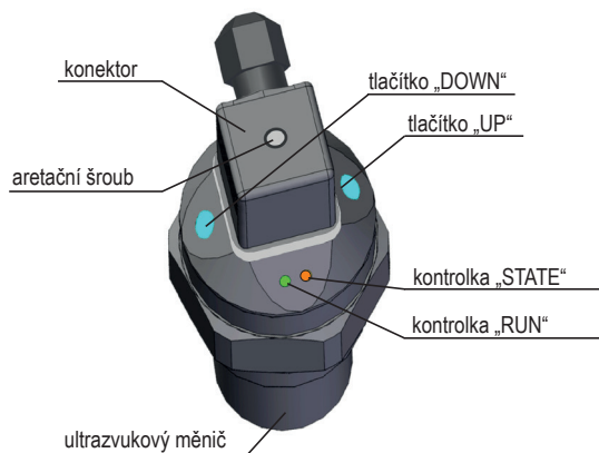
Popis hlavních částí snímače verze "T" s tlačítky
