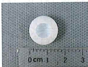
Obr. č. 2: Díl z materiálu PTFE
