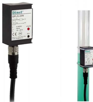
Датчик уровня для уровнемер GPLS–25N предназначен для индикации наличия жидкостей (электропроводящих и не проводящих) в стеклянных или пластмассовых указателях уровня и трубках. Может работать в вертикальном положении - с электроподключением вниз. К указателю уровня (трубке) крепится двумя стандартными ремешками для эл. инсталляции шириной 2,5 мм. 2 шт. прилагаются к каждому датчику в качестве принадлежностей.
