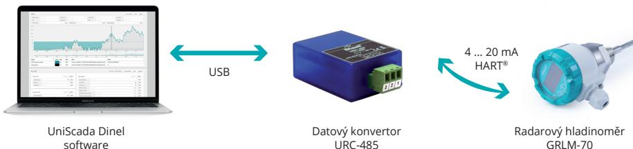
Obr. 48: Připojení periferních zařízení protokolem Modbus pomocí URC-485
