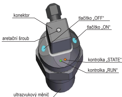
Popis hlavních částí snímače verze "T" s tlačítky
