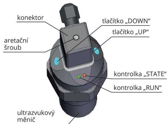
Popis hlavních částí hladinoměru verze s tlačítky
