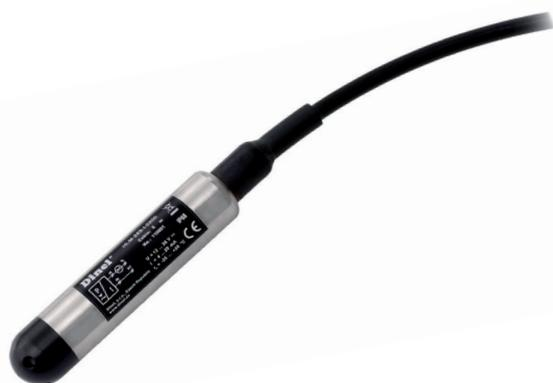
Гидростатический уровнемер HLM-25S является компактным измерительным устройством, содержащим кремниевый тензометрический датчик и оценочную электронику в зонде из нержавеющей стали. Из корпуса зонда выходит кабель с капилляром, который предназначен для подвода сравнительного атмосферного давления в зонд. На лицевой стороне зонда имеется съемная крышка, предотвращающая механическое повреждение мембраны. На уровнемере отсутствуют элементы для настройки.
