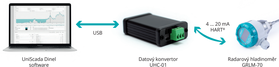
obr. 49: Připojení periferních zařízení protokolem HART® pomocí UHC-01
