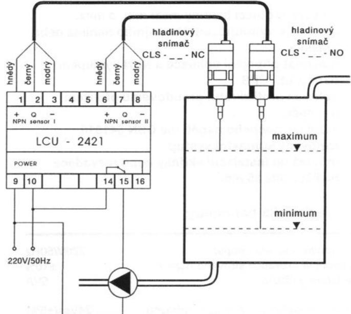
LED "STATE" nesvítí - kontakt 14,15 sepnut - čerpadlo je spuštěno
