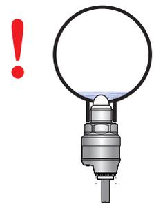
Установка датчика в трубопроводе
