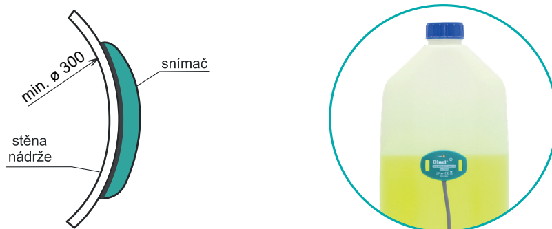
Upevnění FLD-32 pomocí samolepicí vrstvy
