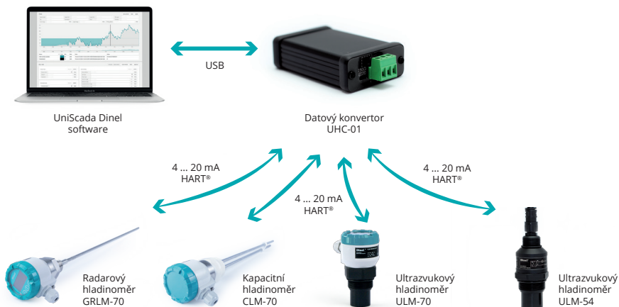
Obr. 18: Možnosti zapojení konvertoru UHC-01
