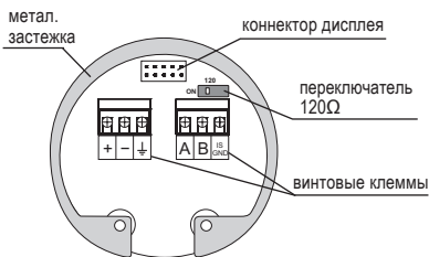
Рис. 17: Вид изнутри на винтовые клеммы измерителя уровня с протоколом Modbus ULM-70_--_M
