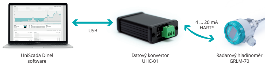
Obr. 47: Připojení periferních zařízení protokolem HART® pomocí UHC-01
