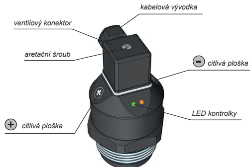
obr. 6: Popis hlavních částí snímače
