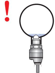
Installation des Sensors in eine Rohrleitung
