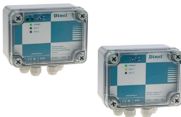
Блоки обработки и коммутации SDSU-1222-W и DSU-1222-W предназначены для определения состояния лимитных датчиков. Содержит источник напряжения для питания датчиков. При помощи DIP переключателей можно выбрать основной режим (независимая функция двух лимитных датчиков) или режим регулировки уровня между миним. и максим. состоянием (докачивание или откачивание).
