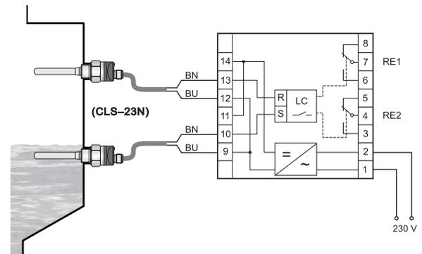
\* Выбор типа датчика на блоке выполняется переключением выключателя «CH 1» и «CH 2» в положение «P» (датчики PO, PC) или в положение «N» (остальные типы датчиков). Взаимная комбинация датчиков PO, PC с иными типами недопустима. Комбинация датчиков NO, NC, SO и SC допустима.
