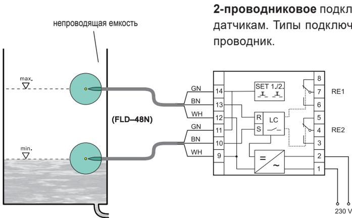
**2-проводниковое** подключение подключения блока **SDSU-1222-W** к лимитным датчикам. Типы подключаемых датчиков SO, SC + + третий программирующий проводник.
