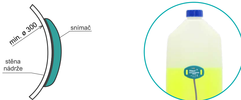
Upevnění FLD-32 pomocí samolepicí vrstvy
