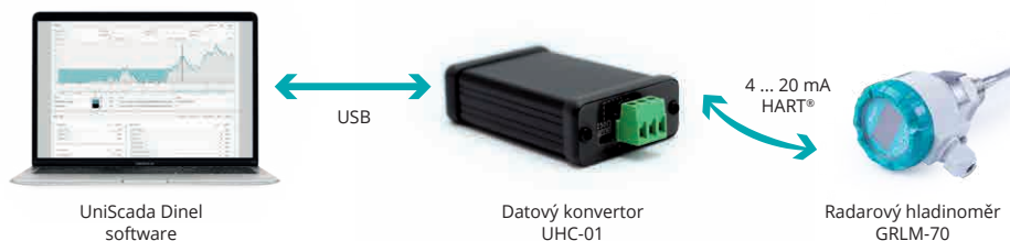
Obr. 47: Připojení periferních zařízení protokolem HART® pomocí UHC-01
