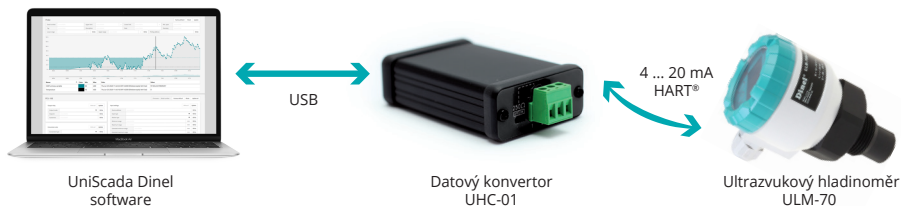
Obr. 22: Připojení periferních zařízení protokolem HART® pomocí UHC-01
